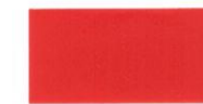
Vermelho Munsell 5 R 4/14 / Rojo 80000 - Identifica equipamentos de proteção e combate a incêndio / Identifica equipo de protección y lucha contra incendios
